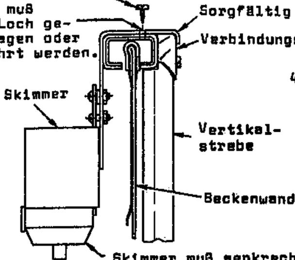
4.) Bei Schwimmbecken mit schmalen Abdeckschienen (wie Type SE), wird die Halteklammer sorgfältig über das Verbindungsstück gebogen, oben ein Loch geschlagen oder gebohrt und mit der Befestigungsschraube fest angeschraubt.
